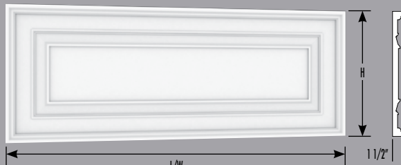
4500 Panneau soulevé Raised Panel L/W: sur mesure/custom sized H: sur mesure/custom sized P: 1 1/2"
