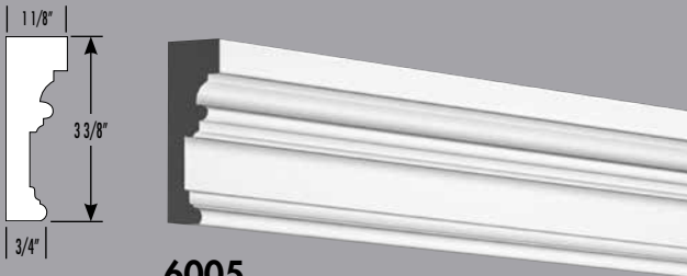
6005 Moulure de portes et fenêtrés Door and Window Moulding H: 3 3/8" P: 1 1/8" Lg: 192"
