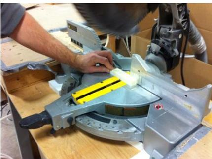
16. En suivant les lignes tracées précédemment comme guide, couper les blocs de fixation à l'aide d'une scie à onglet ayant une lame de finition.
